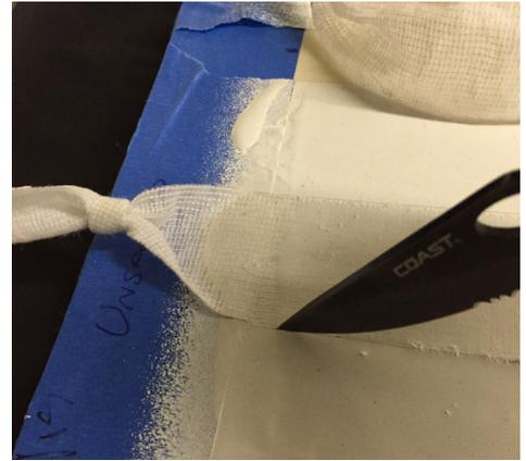
10. Utilizando una báscula de resorte calibrada, enganche el nudo y tire hacia atrás 180 grados, paralelo a la tela.
