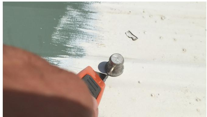
2. Una vez que el adhesivo se ha curado, el probador de adherencia de extracción portátil está unido al puck y se alinea para aplicar la tensión
