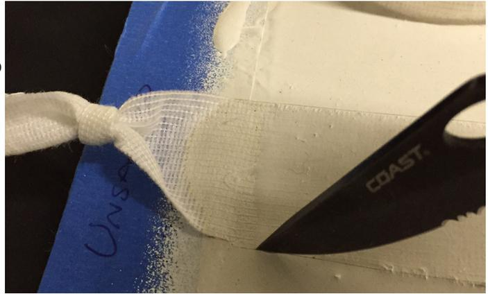
10. Utilizando una báscula de resorte calibrada, enganche el nudo y tire hacia atrás 180 grados, paralelo a la tela.
