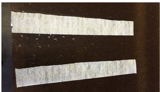
Tiras de tela colocadas sobre el sustrato
